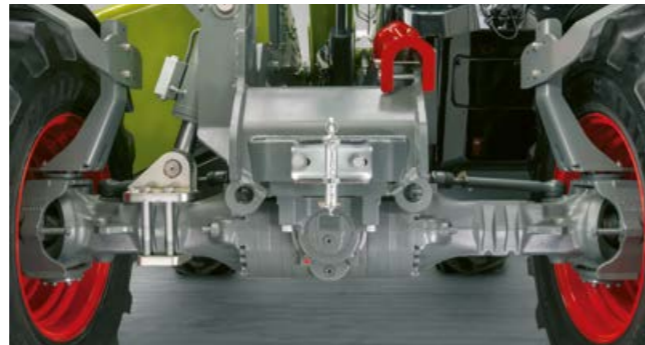
Rėmas su hidrauline išlyginimo funkcija.
