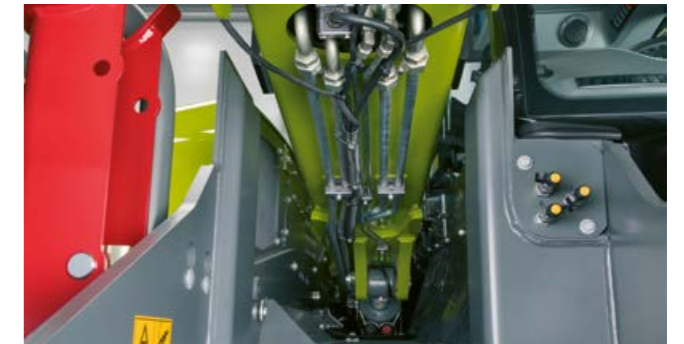
Visuose didesnės kaip 4500 kg keliamosios galios teleskopiniuose krovimo vamzdyje, į rėmą integruota kreipiančioji yra standartinė įranga.
