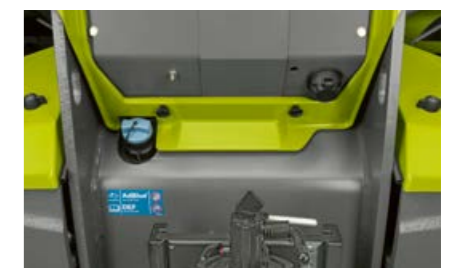
Lengvai pasiekiamas „AdBlue®“, kuris skirtas efektyviam išmetamųjų dujų papildomam apdorojimui, bako kaklelis.
