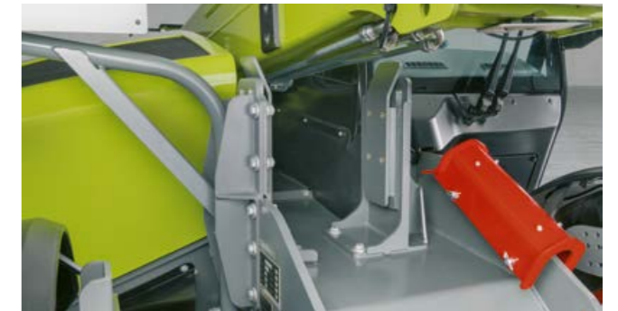
Šoninė teleskopinės strėlės kreipiančioji gali būti sumontuota visuose SCORPION modeliuose.
