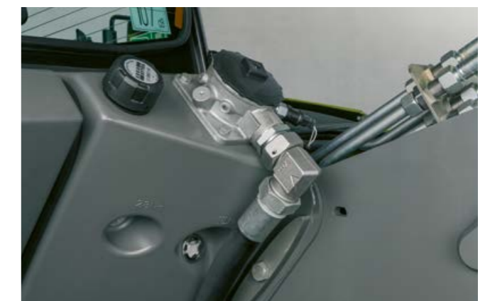
Hidraulinės alyvos lygį galima patogiai patikrinti pro tikrinimo langelį. Hidraulinę sistemą apsaugo grąžinamos alyvos filtras, kurį reikia pakeisti tik kas 1000 darbo valandų.
